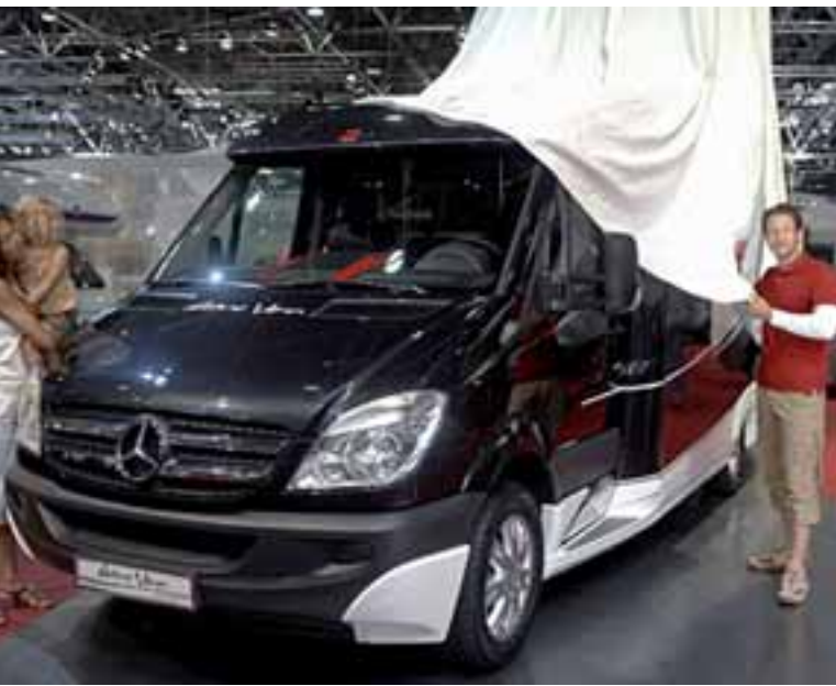
■ Aerodynamik und leichte Bauweise sollen beim Technologieträger Bürstner Aero Kraftstoff sparen.
